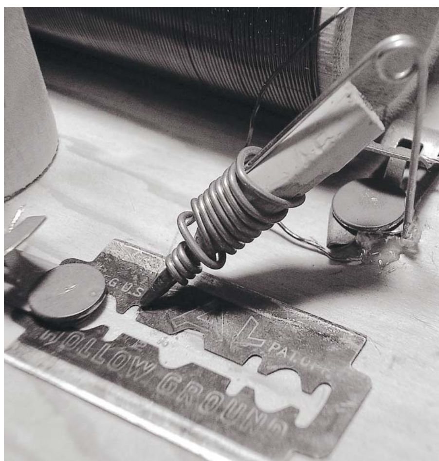
Dieses Rasierklings-Radio wurde von Kriegsgefangenen um 1940 gebastelt – Lewis Dartnell empfiehlt es für den Neustart der Welt.
